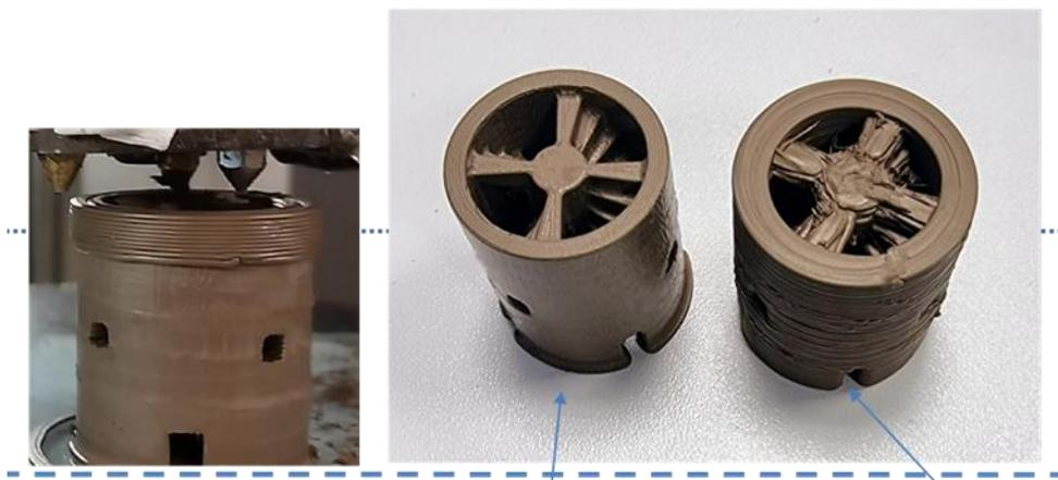
Figure 2: Tour de gauche à droite : dernière étape d'impression, tour usinée et tour brut sans usinage
